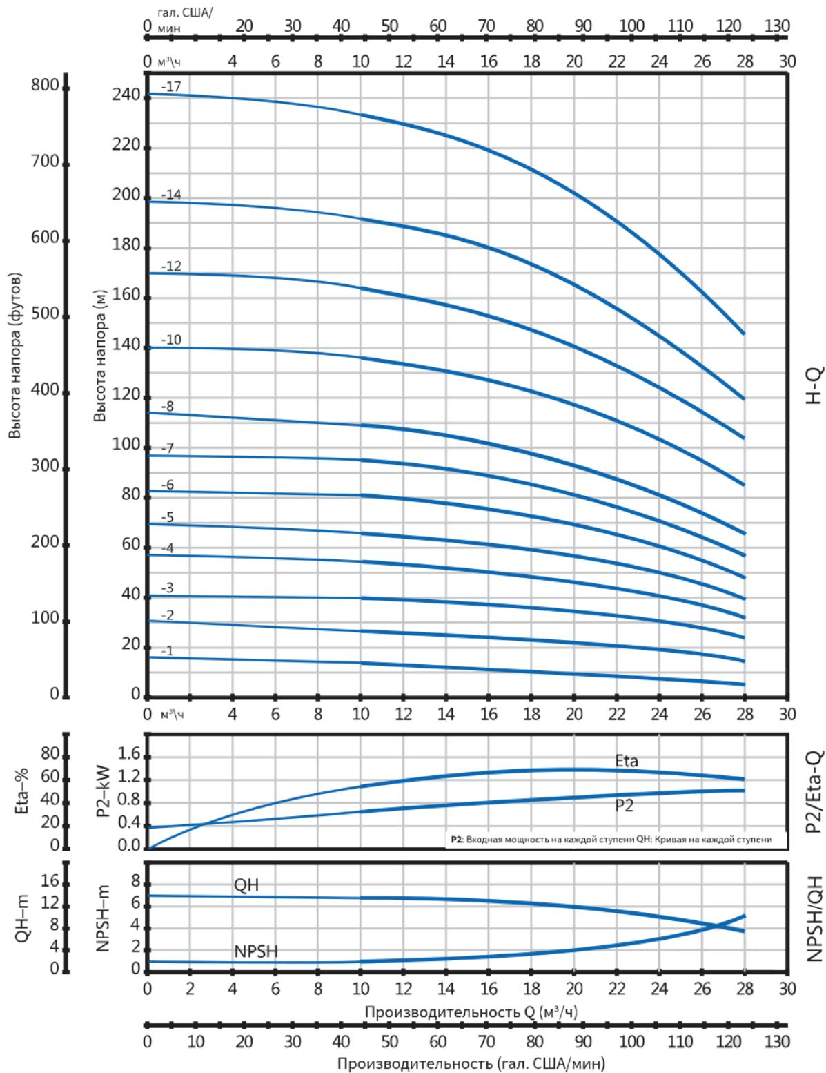
Измерения произведены для чистой воды, температурой 20°C и вязкостью 1 мм<sup>2</sup>/с.
